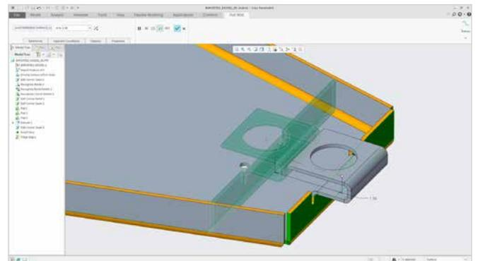
インポートした部品のジオメトリ パターンを認識し、ジオメトリの変更をパターン メンバーに伝播します。
